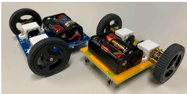
図5 試作したライトレーサー、電源は単5電池を用いた(左:デジタルライトレーサー、右:アナログライトレーサー)
