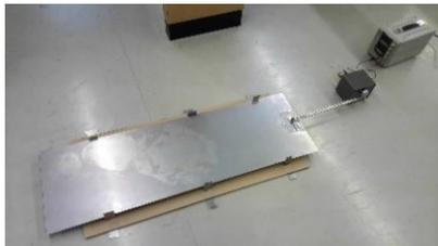
図2 自作の振動装置
