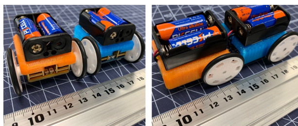
Fig. 5 アナログ回路 (それぞれの写真の左側) とデジタル回路 (それぞれの写真の右側) で構成された同等の機能のライトレーサーの背面 (左の写真) と側面 (右の写真)、一緒に写っている定規や格子模様のマットからもボディ幅3cm程度、長さ4cm程度であることがわかる。
