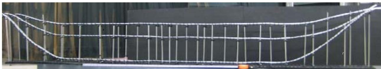
のような実験装置を工夫することで、感動的な実演を提示することができた。高校1年の回答者24人中、23人が「同時につく」と回答したが、大方の予想に反して一番下のコースの球がはるかに早く先端に達した。これをビデオポイントで効果的に可視化して、分かり易く検証した。この感動的な予想・検証実験を経て、「位置エネルギーが運動エネルギーに転化」するエネルギー概念の理解を飛躍的に深めることができた。
