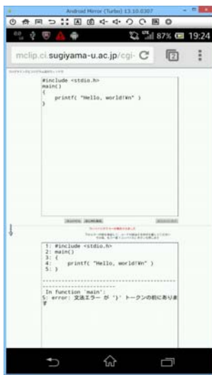
Fig.4 文法エラーのあるプログラムのエラー出力の様子
