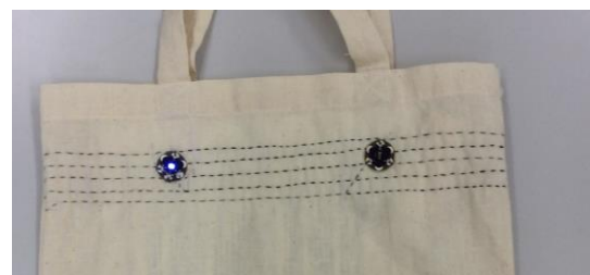
図 6 : 図 3 の回路の入力・出力を縫い付けた側 (右側が入力のセンサーで、左側が出力の LED。入力と出力の間の糸は黒の刺繍糸で、電気は通さない)
