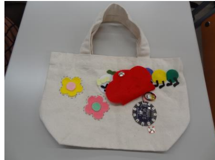
図8：LilyPad Arduino を組み込んだ鞆
