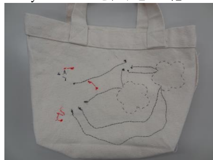
図9：図8の作品の裏側 (ねずみ色の線はすべて導電線)
