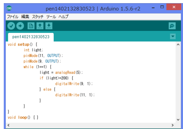
図 5 : Arduino 用に自動変換されたプログラム
