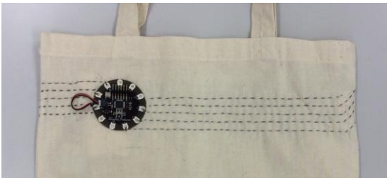
図7：LilyPad Arduino を縫い付けた側 (表側の入力と出力に導電線が繋がっている)
