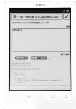
Fig.3b Fig.3a で実行したコマンド引数の文字列を受け取って、大文字にして表示した結果の例
