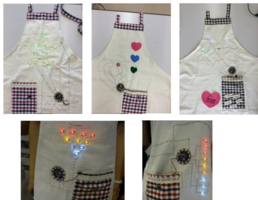
図 3 完成したエプロンコンピューター
