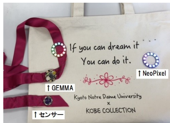
図 5 NeoPixel と Arduino GEMMA を利用した作品
