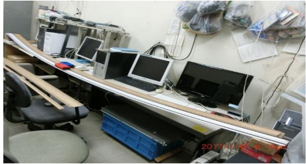
図3. よく曲がるスマートカート用 4m 級手作り滑走台
