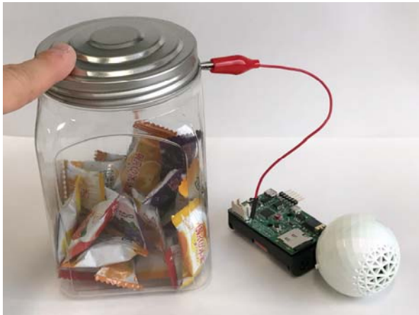
Fig. 4 触れると教えてくれる器（フタの部分に触ると、飴が入っていることを音声で返し、さらに本システムを飴入れの下に設置することで、標準で実装されている光センサの情報から、飴の量を答えるツールとして作成した事例)
