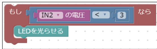
図 10 センサを利用する時のプログラム例
