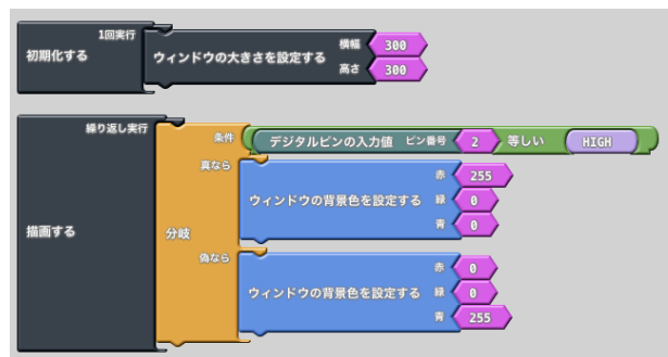
図 6 タクトスイッチと描画を連携させるプログラム
