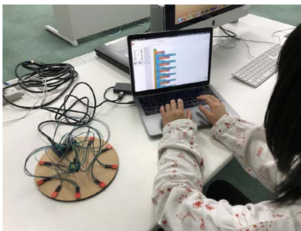
Fig.8 タッチセンサによって、サウンドを発生させる楽器ツールのプロトタイププログラミングを行っている様子。
