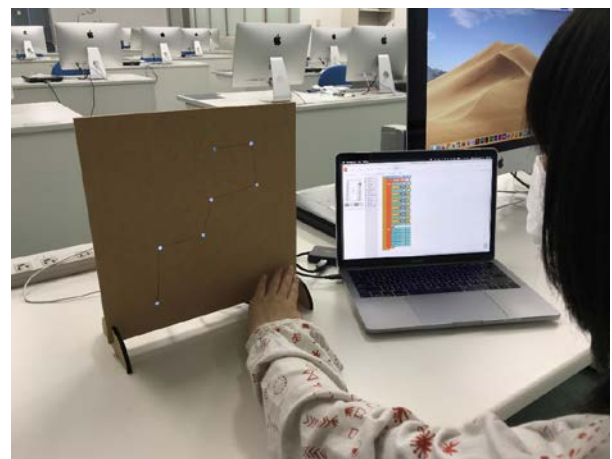
Fig.6 Fig.5 の作品のプログラミングを確認している様子。今回はマイコンに PICAXE14M2 の表面実装タイプを用いたので、ビジュアルプログラミングも可能。
