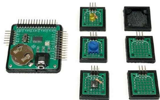
Fig.2 マイコン(14ピン)、ピンヘッダ等を取り付けたプラットフォームの基板(左)と、LED、可変抵抗、タクトスイッチ、センサ等を取り付けた基板(右)、各基板のフレームを 3D プリンタで形成した。
